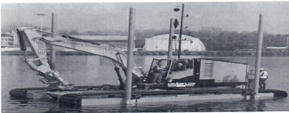
La eficiencia del equipo es de 475 m<sup>3</sup>/h de acuerdo con las especificaciones del fabricante. Por recomendaciones de la interventoría se afectará al 70% para medir su rendimiento lo que equivale a 333m<sup>3</sup>/h. Considerando una sedimentación estimada de 40% quedaría un rendimiento de 199.5m<sup>3</sup>/h. Para realizar la remoción de sedimentos de esta unidad se realizarán turnos diarios entre las 7 y 18 horas con un tiempo de bombeo efectivo de 8h por día.
